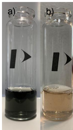
Figura 47. Mezcla de los colorantes RC-VM-AM a) antes y b) después de la degradación
